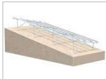
STEP4: 横レール・プレースの設置
