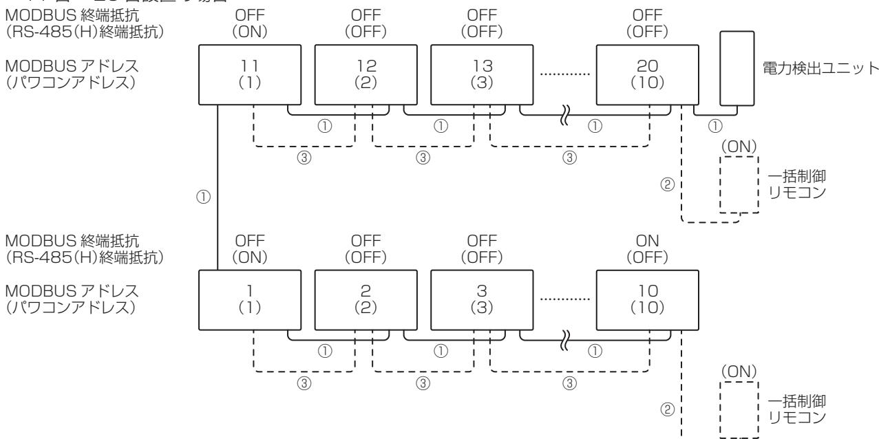
MODBUS コネクタが 2 か所あるパワーコンディショナがありますが、どちらを使用しても構いません。太陽光パワーコンディショナの MODBUS スイッチを ON、または通信切替スイッチを MODBUS にしてください。また、MODBUS 終端抵抗、アドレスを設定してください。一括制御リモコン (SPUR-1MA-LP) を接続する場合は、太陽光パワーコンディショナの独自通信 RS-485(H) の終端抵抗、アドレスも設定してください。
