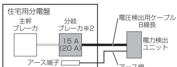
※ 1 太陽光発電システム専用ブレーカ（または住宅用分電盤）の施工説明書等を確認し、端子の共締めが不可とされている場合は、別途「極数3の分岐ブレーカ」を設置してください。
