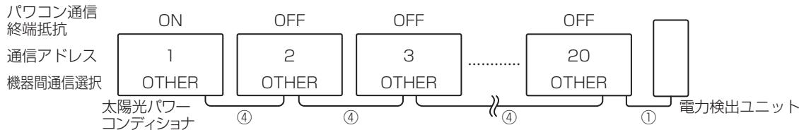
太陽光パワーコンディショナのパワコン通信終端抵抗と通信アドレス、機器間通信選択は、配線図に従って設定してください。
