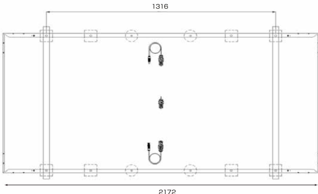
ネジ固定方法:外側の4つ、内側の4つの穴を使用して取り付けます。
