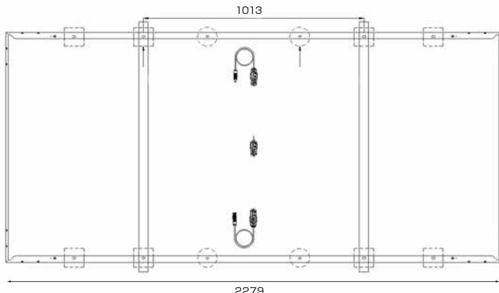
ネジ固定方法:外側の4つ、内側の4つの穴を使用して取り付けます。
