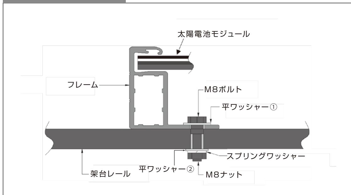
取り付けるときは、M8防錆ネジ、スプリングワッシャー、平ワッシャーを使用して太陽電池モジュールをレールに取り付けます。特殊なブラケットシステムや特殊な取り付け方法が必要な場合ブラケットの供給元に再度トルク値を確認してください。
