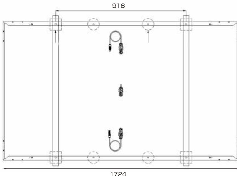
ネジ固定方法:外側の4つの穴を使用して取り付けます。
