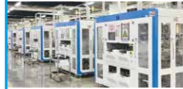
セルに配線材を溶着し、自動で直列配線して「ストリング」を作成します。
