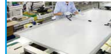
組み立て後、ジャンクションボックスを取り付けます。
