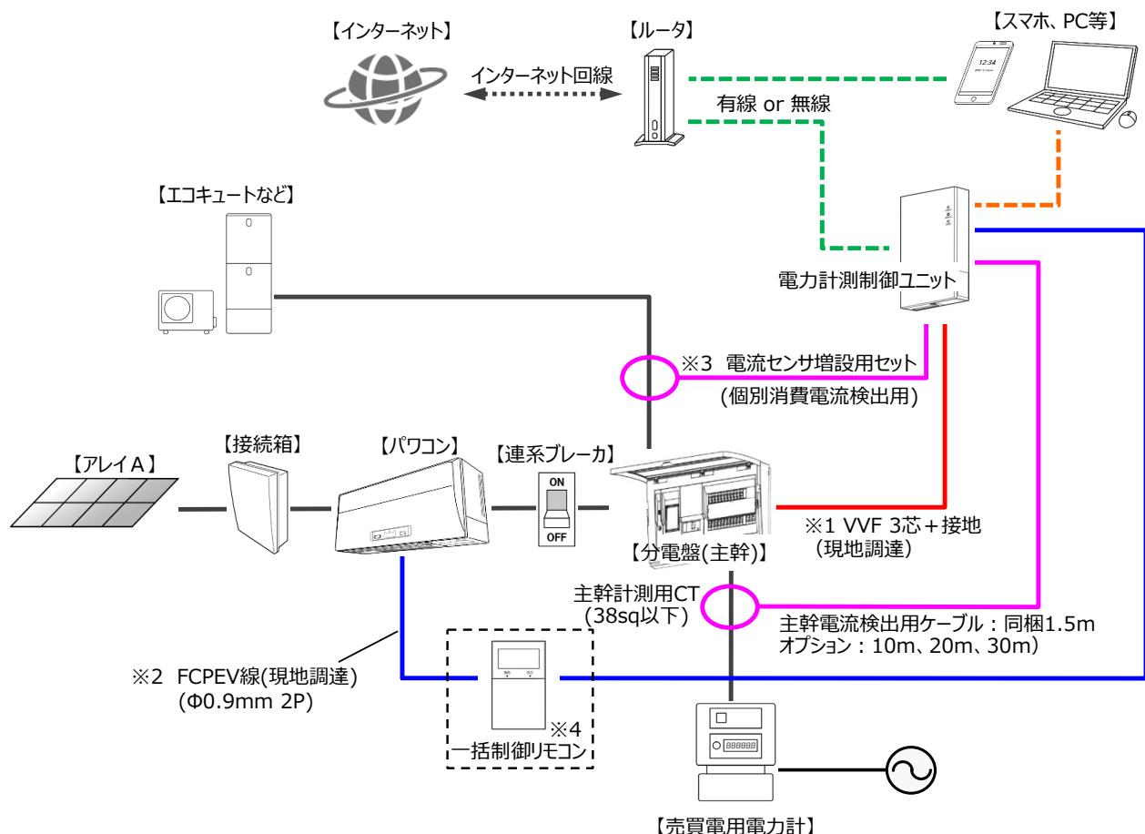
※1 電圧検出用ケーブルは、VVF3芯(Φ 1.6/2.0mm)を現地手配。接地線も接続が必要(VVF4芯も選択可)。
